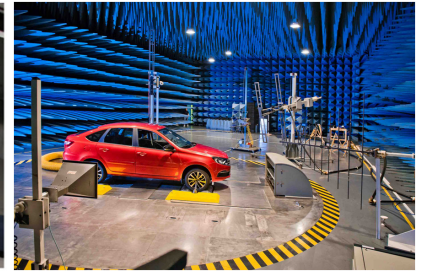
Рис. 2. Испытания на помехоустойчивость автомобиля в полубезэховой камере с применением излучающих антенн
