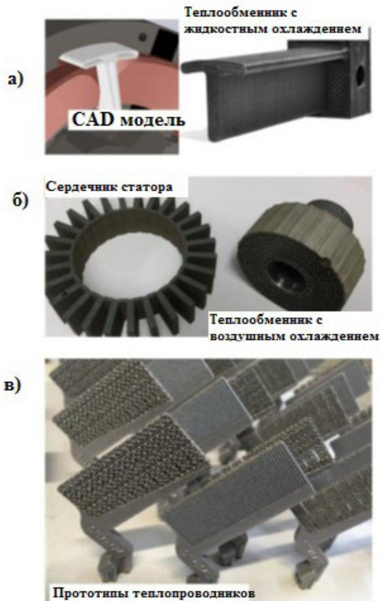
Рисунок 6/ Элементы систем терморегулирования для электрических машин
