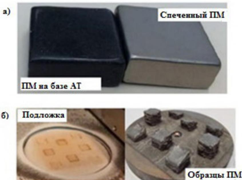
Рисунок 8. Технология изготовления ПМ на базе АТ
