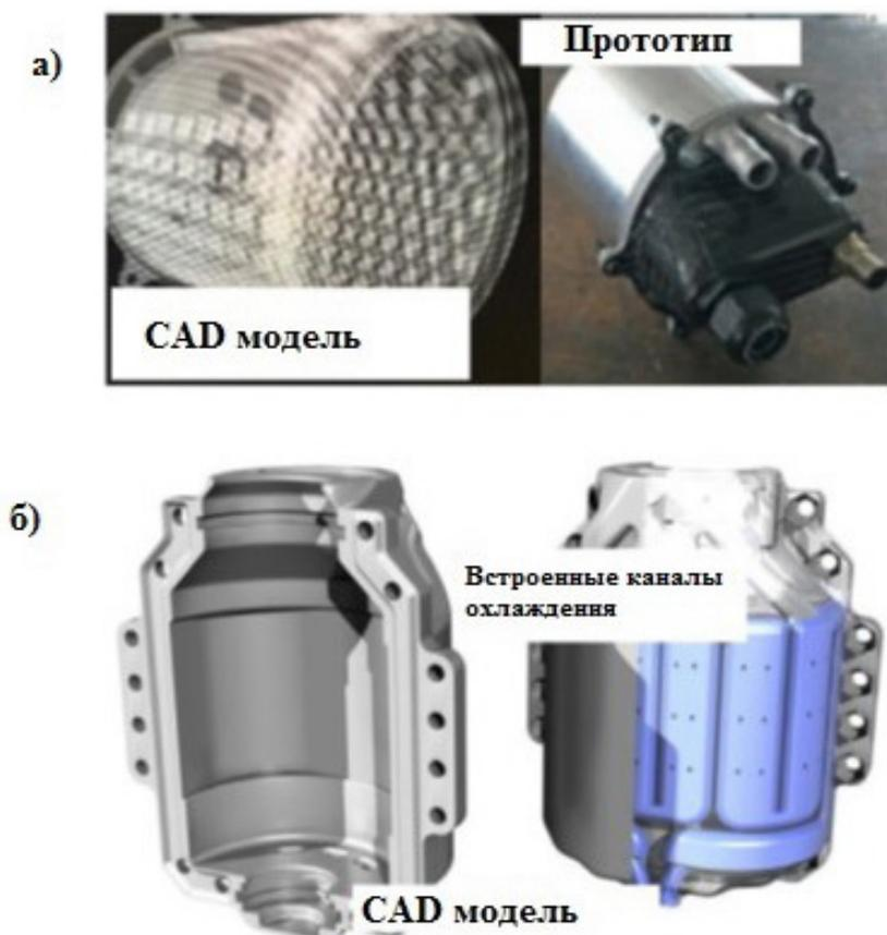
Рисунок 3. Корпус двигателя со встроенными каналами охлаждения
