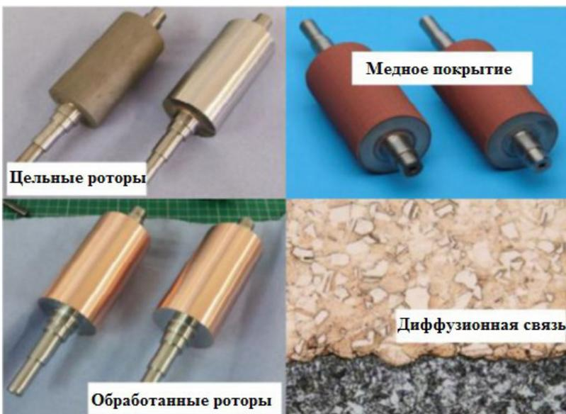
Рисунок 5. Цельные стальные роторы с медным покрытием для высокоскоростной индукционной машины – Rolls Royce Central Technology [17]
