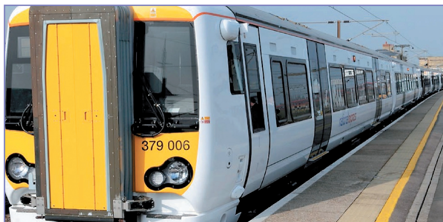
Рис. 4. Моторвагонный контактно-аккумуляторный электропоезд Electrostar, работающий на британских железных дорогах
