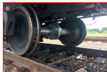
Рис. 5. Приложение нагрузок к ТКП в процессе определения масштабов измерения тензометрических схем: а) при вертикальном нагружении; б) при боковом нагружении
