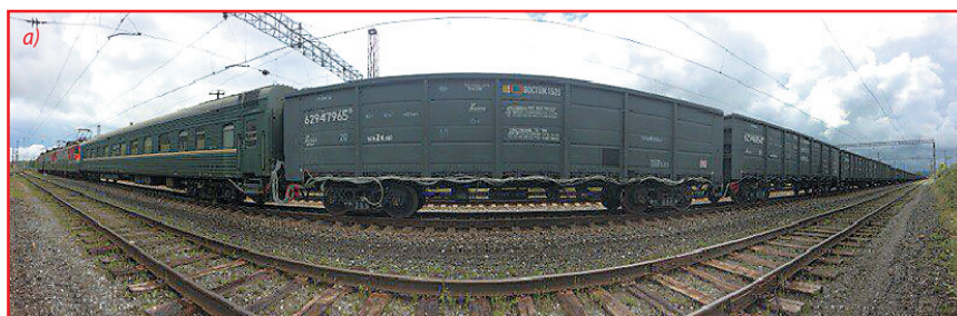
Рис. 6. Опытный сцеп: а) исследуемый полувагон модели 12–9548–01; б) установленная под исследуемый полувагон ТКП
