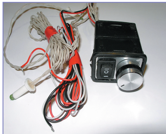
Рис. 6. Автоматический регулятор частоты вращения вентилятора отопителя
