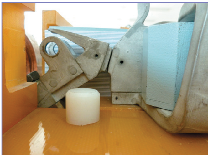
Рис. 6. Контакты выключателя во включенном положении.
