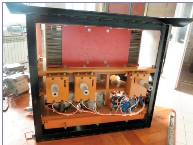
Рис. 5. Выключатель ВВ 10/1–630/8 со стороны установки датчиков тока.
