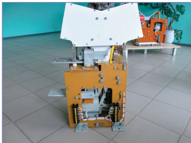
Рис. 10. Выключатель БВ 24/1–2000/10Л.
