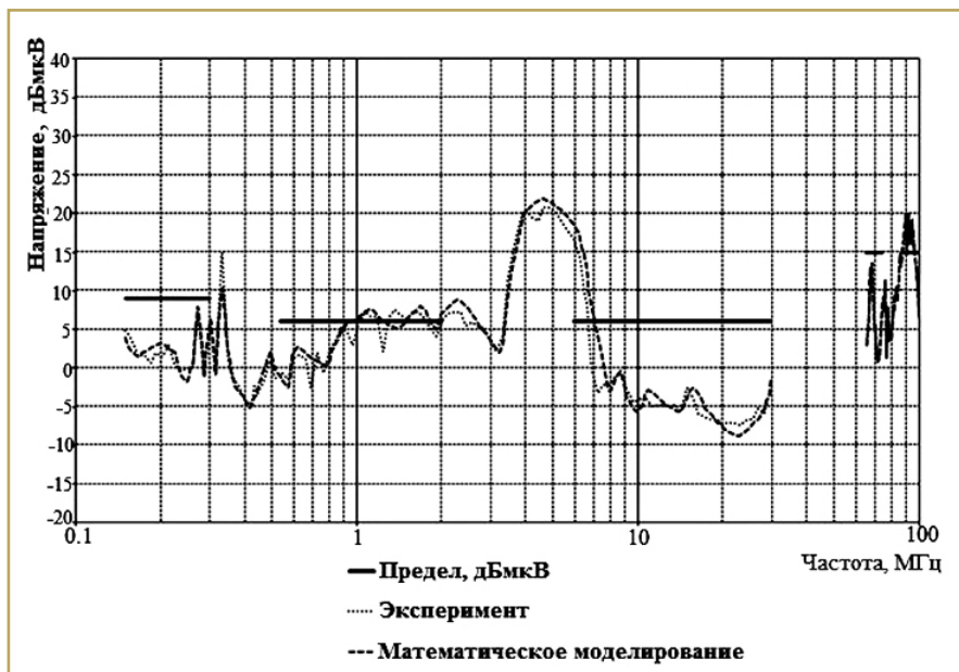
Рис. 3. Моделирование электромагнитных помех от системы зажигания.
