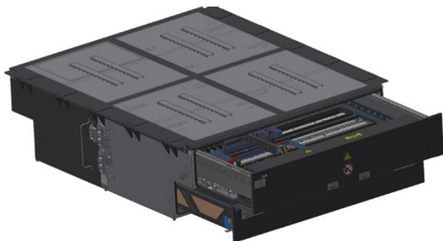
Рис. 2. Контейнер с тяговыми накопителями
