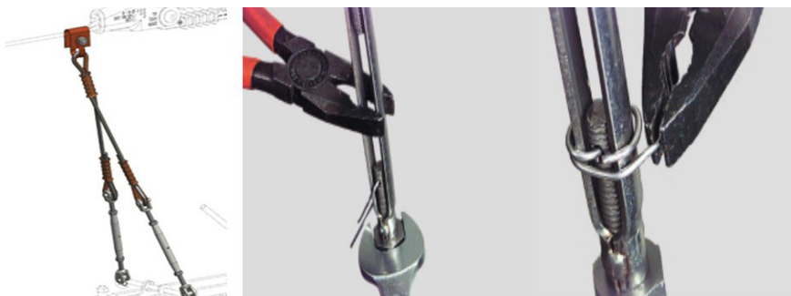
Рис. 7. Предложенный вариант подвеса: а) – металлические струны, б) – регулировка металлических струн
