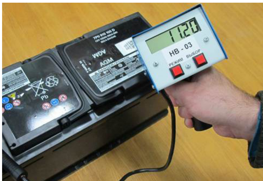
Рис. 4. Измерение напряжения АКБ нагрузочной вилкой НВ-03
