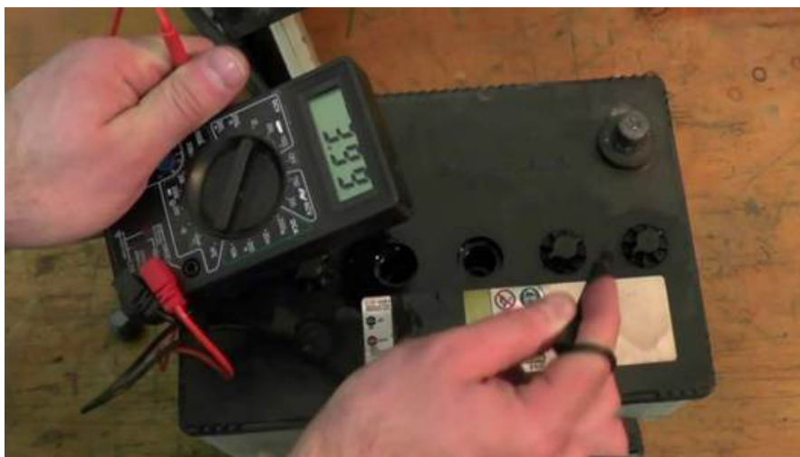
Рис. 1. Измерение токов саморазряда
