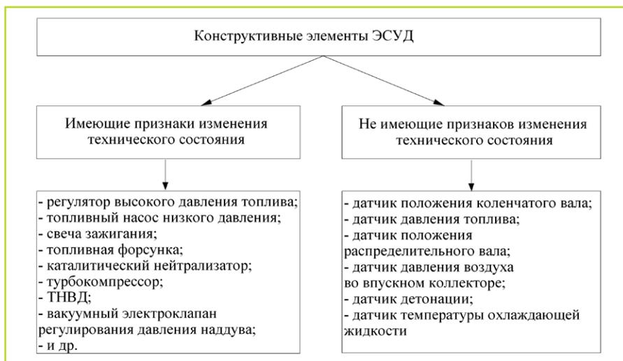
Рис. 2. Классификация элементов ЭСУД по возможности диагностирования их технического состояния.
