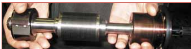
Рис. 6. Ротор электродвигателя ДБ160-30000-60-U.
