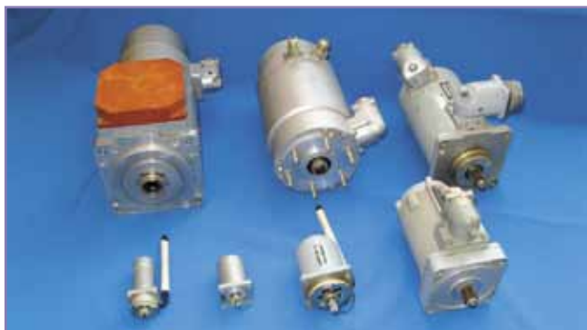
Рис. 1. Вентильные электродвигатели разработки ОАО «Электропривод».
