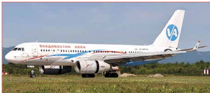
Рис. 6. Самолет ТУ-204 (двигатель ПС-90А с РУ решетчатого типа). Пробег, реверс тяги включен [2].
