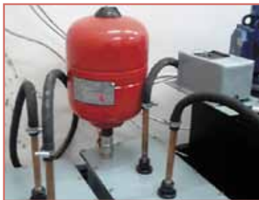
Рис. 8. Система подогрева масла.
