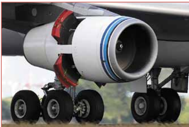
Рис. 4. Включенный реверс самолета А340-313 (двигатель CFM56-5С4/Р).
