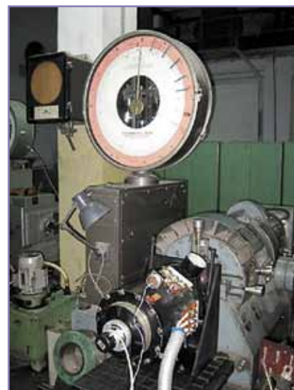
Рис. 6. Нагрузочный стенд SIEMENS с установленным генератором ГТ40ПЧ8.
