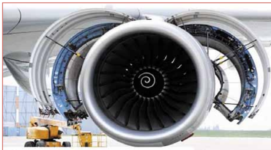
Рис. 9. Электромеханическая система РУ, установленная на шпангоуте А380.
