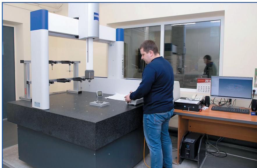
Рис. 4. Координатно-измерительная машина Contura G2 10/12/6 Aktiv Carl Zeiss
