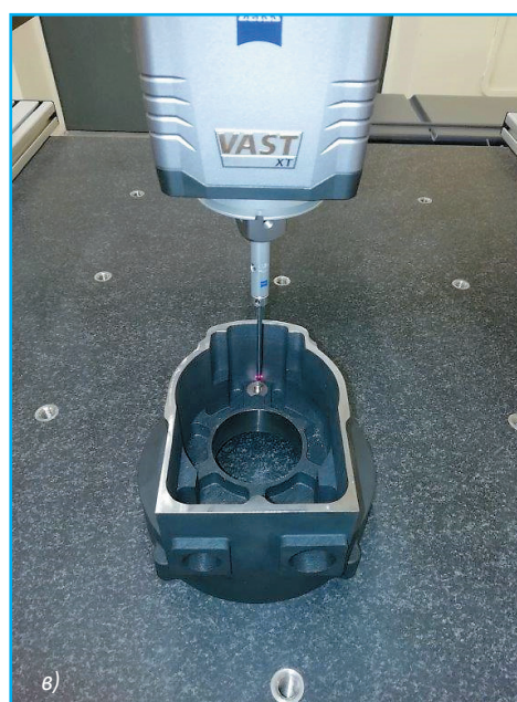
Рис. 3. Корпусная деталь: изготовление из титановой плиты (а), изготовление методом 3D-печати (б); контроль на координатно-измерительной машине детали, изготовленной методом 3D-печати (в)
