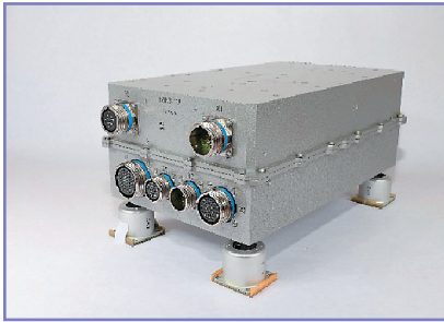
а) Изделие, на котором проверялась эффективность рассчитанного ККМ: блок управления и контроля перспективным электродвигателем (а); электромеханизм (б)
