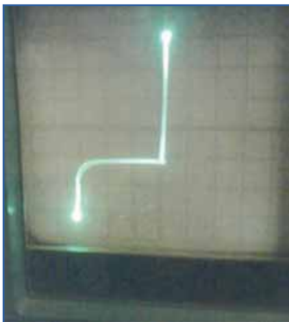
Рис. 9. Вольт-амперная характеристика экспериментального непланарного выпрямительного диода с цилиндрическим р-п переходом. Масштаб координат (1 мА x 30В клетка).
