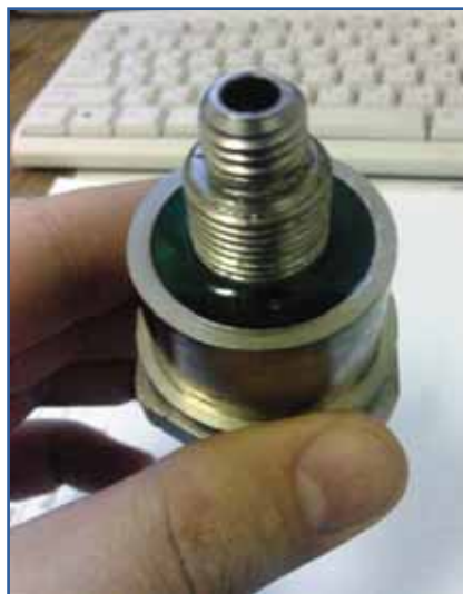
Рис. 8. Экспериментальный образец непланарного выпрямительного диода с замкнутой областью пространственного заряда.
