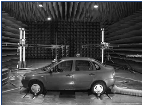
Рис. 1. Камера для испытаний электроники и электрооборудования в составе автомобилей на устойчивость к внешнему электромагнитному полю.
