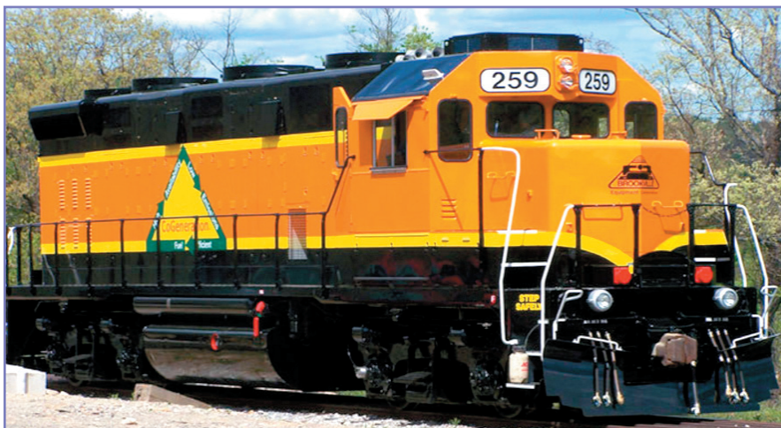
Рис. 1. Тепловоз серии CoGeneration™ компании Brookville Equipment Corporation с нулевым потреблением топлива в режиме реостатного торможения
