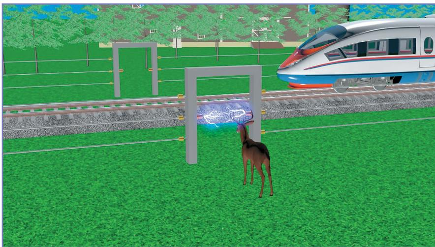
Рис. 2. Работа отпугивающих устройств при приближении подвижного состава к ответственному участку пути
