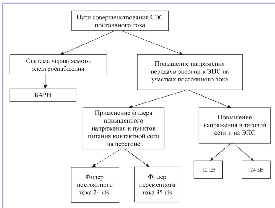
Рис. 1. Пути совершенствования системы тягового электроснабжения постоянного тока
