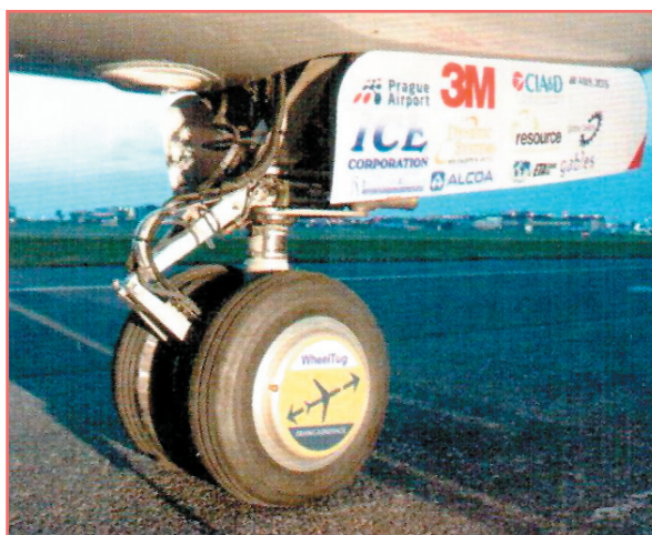
Рис. 1. Устройство WheelTug в составе стойки передней опоры шасси.
