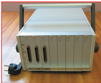
Рис. 5. Внешний вид 8-местного крейта с установленными модулями.
