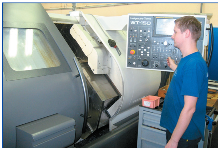
Рис. 3. Обрабатывающий центр NAKAMURA TOME WT150.
