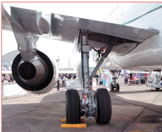
Рис. 2. Электрическая экологичная система руления EGTS, разработанная Honeywell и Safran.
