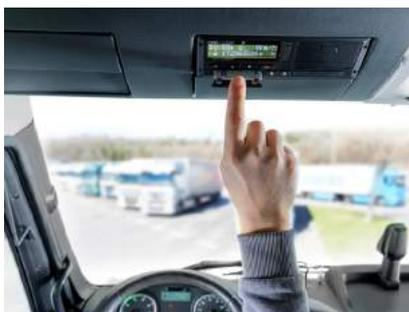
Рис. 2. Пример смарт-тахографа в грузовом автомобиле [14]
