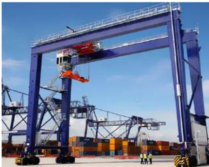
*Рис. 5. Автоматический электрический козловой кран [24]*
