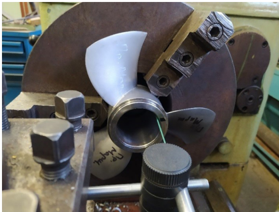
Рис. 5. Оборудование для измерения магнитной индукции магнитов в ступице гребного винта
