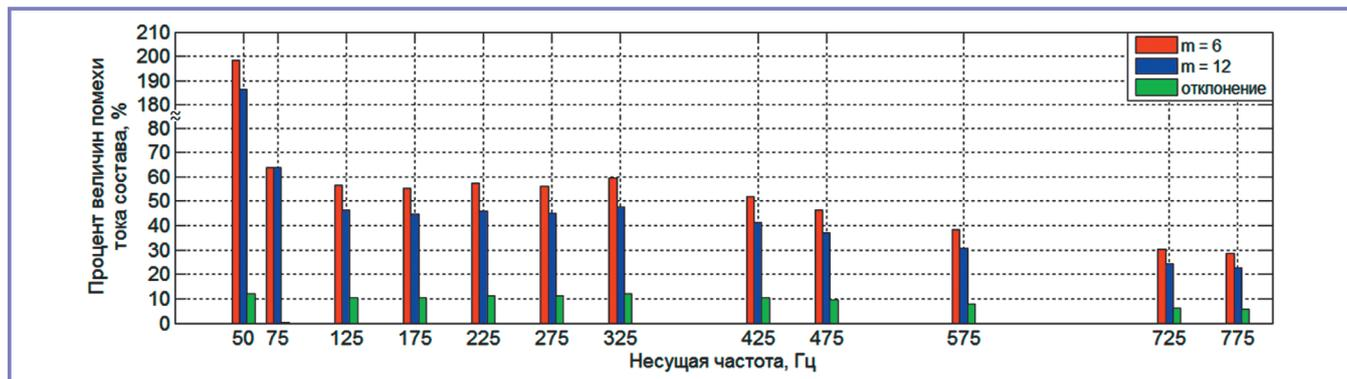
Рис. 8. Столбчатая диаграмма максимальных величин действующих значений гармоник тягового тока ЭПС на несущих частотах в процентном соотношении к нормируемым уровням по результатам моделирования с 6- и 12-пульсовыми схемами выпрямления.
