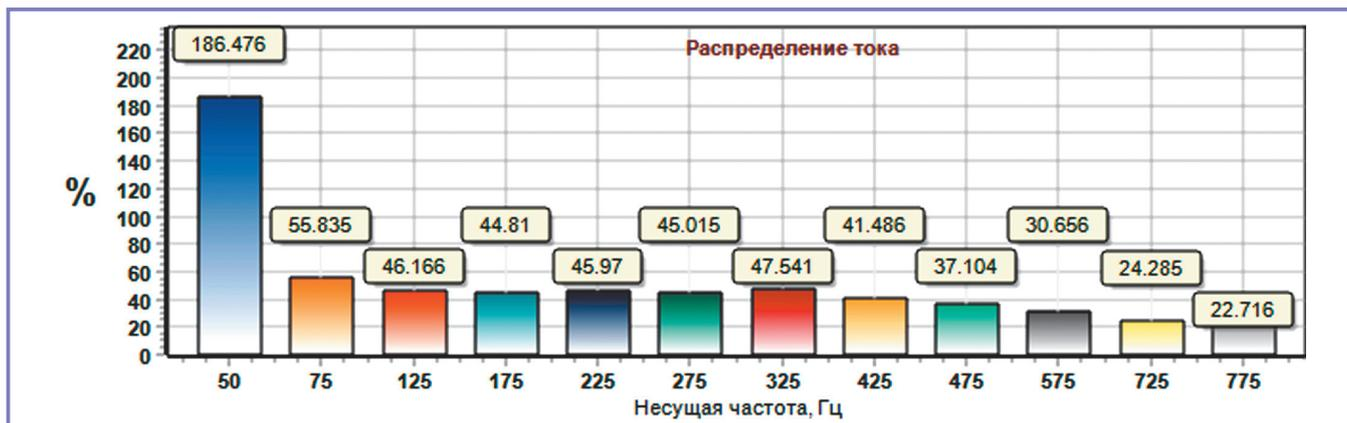
Рис. 6. Столбчатая диаграмма максимальных величин действующих значений гармоник тягового тока ЭПС на несущих частотах в процентном соотношении к нормируемым уровням по результатам моделирования работы ТП с 12-пульсовой схемой выпрямления.
