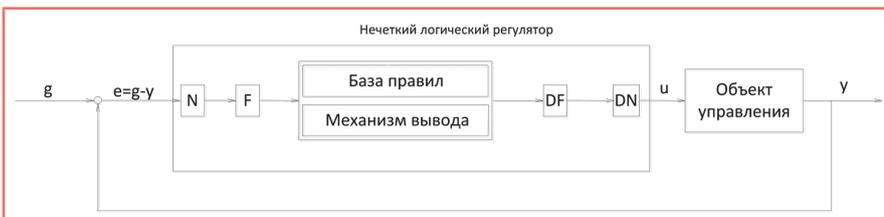
Рис. 3. Структура системы автоматического управления с простейшим нечетким регулятором П-типа.
